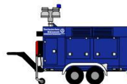
Netzersatzanlage 50 kVA mit Beleuchtungsmast
