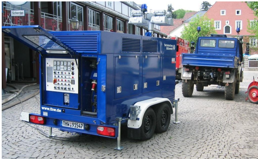
Stromversorgung für die Pumpen zum Auspumpen des Parkhauses in Marktredwitz nach Unwetter
